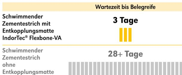
Gemäß DIN 18157 sind Fliesenarbeiten auf schwimmend verlegtem Estrich nicht vor 28 Tagen auszuführen. Bei Einsatz der IndorTec® FLEXBONE-VA ist eine Verlegung schon nach Begehrbarkeit des Estrichs möglich (2-3 Tage).
