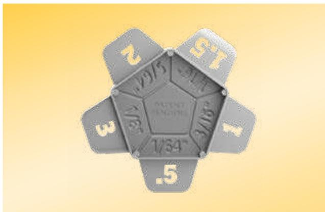
Der IndorTec® FA Fugenabstandshalter sorgt für eine einheitliche Fugenoptik bei kalibrierten, rektifizierten Fliesen und Naturstein. Es sind Fugenbreiten von 0,5 bis 3 mm möglich. Durch Kombination von zwei Fugenabstandshaltern sind Fugenbreiten bis 6 mm möglich. Mit einer Abstufung von 0,5 mm gewährleistet der Fugenabstandshalter ein gleichmäßiges Fugenbild.
