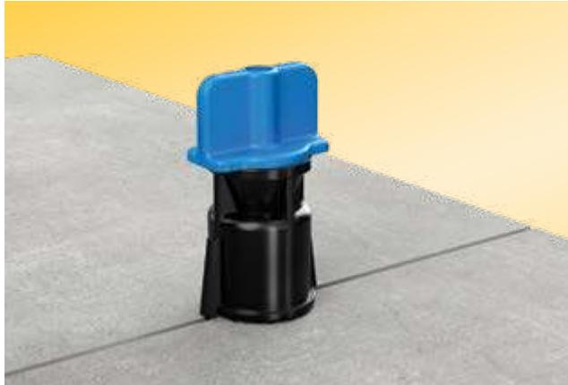
Das IndorTec® FN Nivelliersystem richtet Fliesen und Platten, auch Großformate, akkurat zueinander aus. Unebenheiten durch Überzähne gehören der Vergangenheit an. Die Anwendung ist ausgesprochen einfach in nur 3 Handgriffen: Aufstecken, Arretieren, durch Drehung fixieren. IndorTec® FN verankert sich in der offenen Fuge, dadurch verursacht es keinerlei Kratzer oder Abdrücke auf der Belagsoberfläche.
